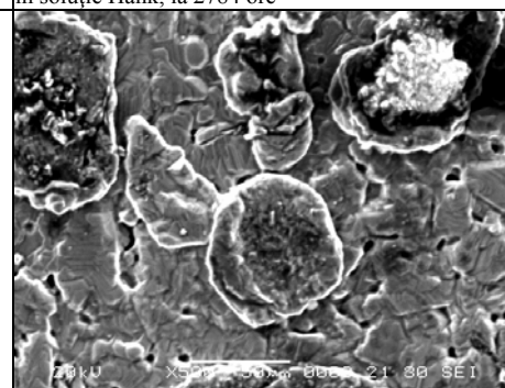
Fig.13. Imagine SEM a titanului sinterizat testate în soluție Ericsson, la 2784 ore
