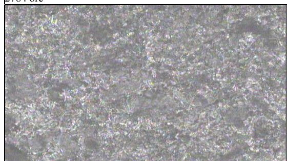
Fig.4. Morfologia suprafeței testate în soluție Carter modificată, la 2784 ore
