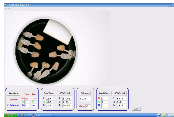
Fig. 5. Determinarea valorilor L_1^* , a_1^* , b_1^* cu ajutorul software-ului DetColorDent 1.1.
